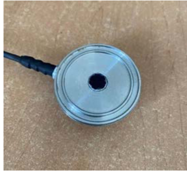
Fig. 5. Micrófono electret adaptado a campana de estetoscopio.
