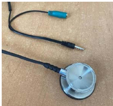
Fig. 9. Sistema de auscultación con salida Jack 3.5 mm y conector para auriculares.
