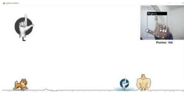
Fig. 7. Prueba del juego usando la red neuronal en conjunto a la visión artificial para evadir obstáculos detectando LSM.
