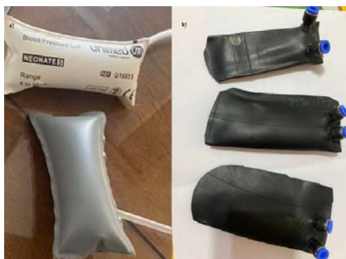
Fig. 1. Diseño de las primeras dos propuestas para los actuadores: a) Actuadores de brazaletes neonatales de presión no invasiva; b) Actuadores hechos a base de cámara de motocicleta.
